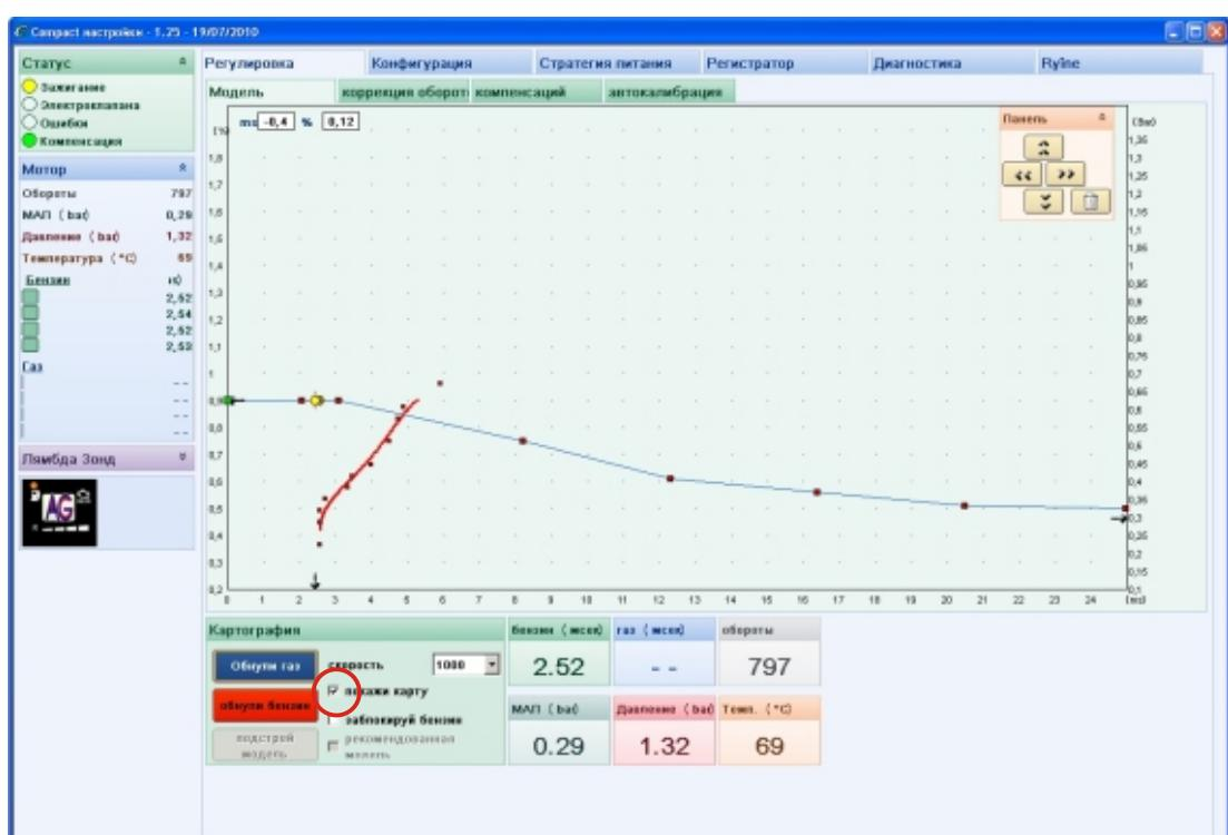
**Если точки видны в полном диапазоне нагрузки двигателя и видна усредняющая штриховая линия, то можно перейти к созданию газовой карты. Во время пользования системой карты автоматически обновляются. Для выключения обновления бензиновой карты следует обозначить опцию «Блокируй бензин».**
