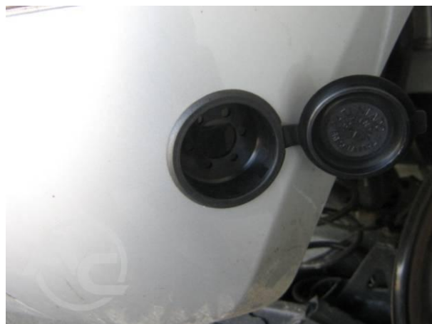
Рис. 1.3.2 Монтаж крышки заправочного клапана
