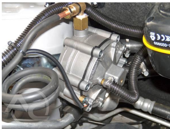
Рис. 1.3.26 Подключение редуктора
