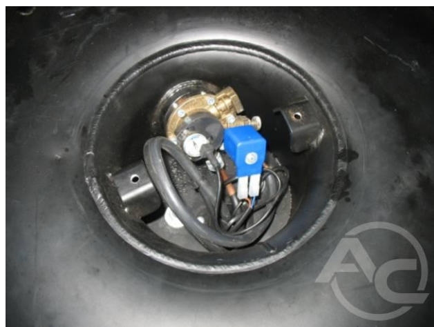
Рис. 1.3.19 Внешний вид подключенного мультиклапана
