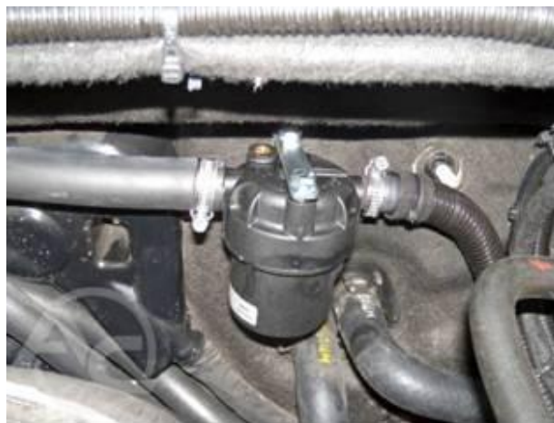
Рис. 1.3.28 Фильтр газовой фазы LPG
