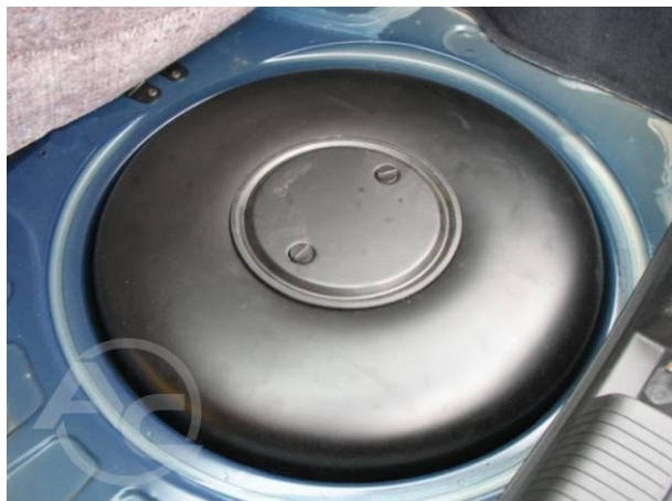
Рис. 1.3.10 Внешний вид установленного бака
