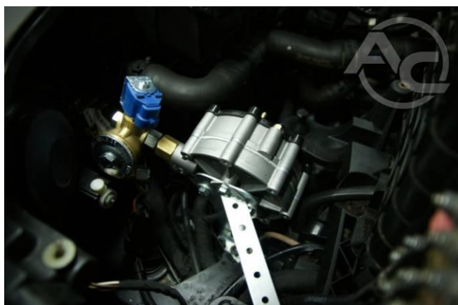
Рис. 1.3.25 Крепление редуктора
