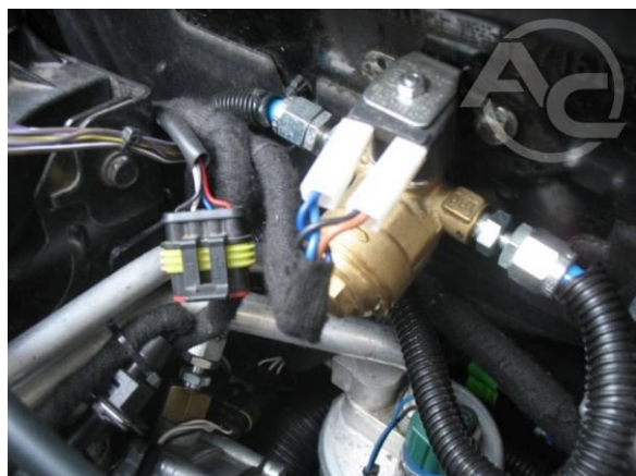
Рис. 1.3.23 Соединение проводки с электроклапаном.
