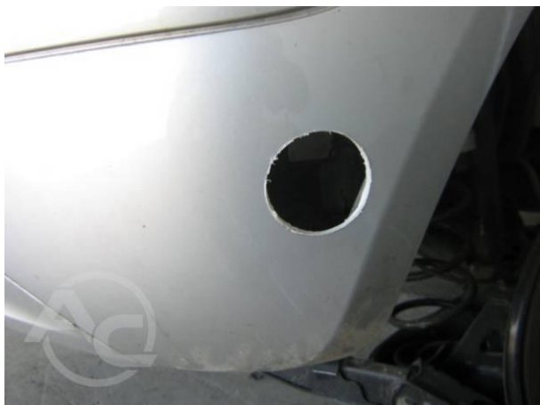
Рис. 1.3.1 Изготовление отверстия в бампере
