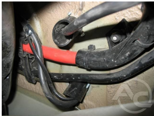
Рис. 1.3.17 Выход втулки под транспортное средство
