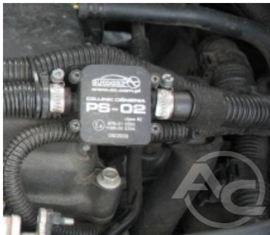
Рис. 1.3.30 Датчик, тип PS-02
