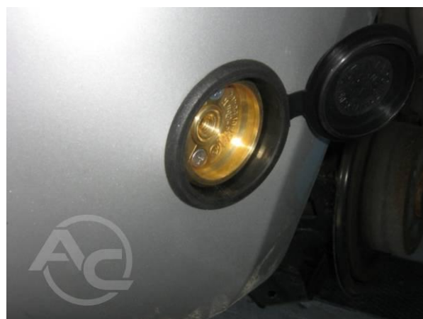
Рис. 1.3.4 Внешний вид заправочного клапана с внешней стороны
