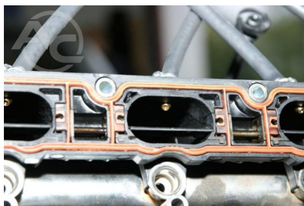
Рис. 1.3.34 Место монтажа сопел (вид изнутри канала коллектора)
