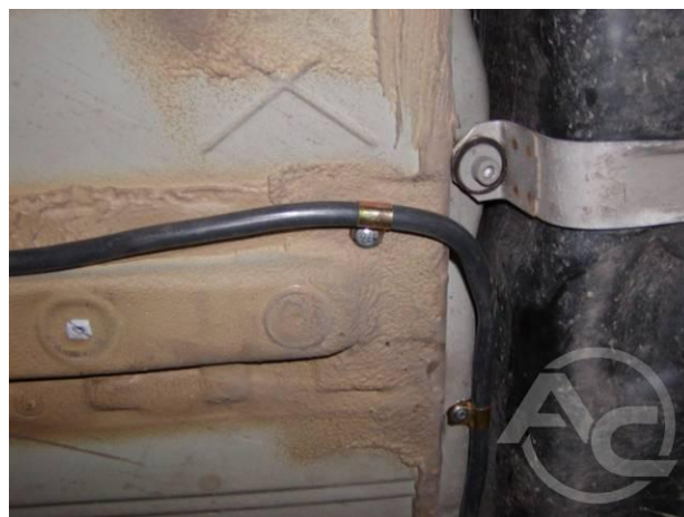
Рис. 1.3.22 Крепление с помощью металлических хомутов
