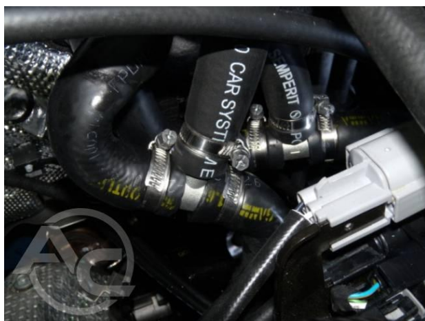
Рис. 1.3.27 Подключение редуктора к системе охлаждения
