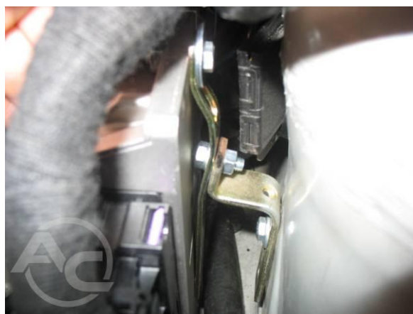
Рис. 1.3.32 Внешний вид крепления контроллера
