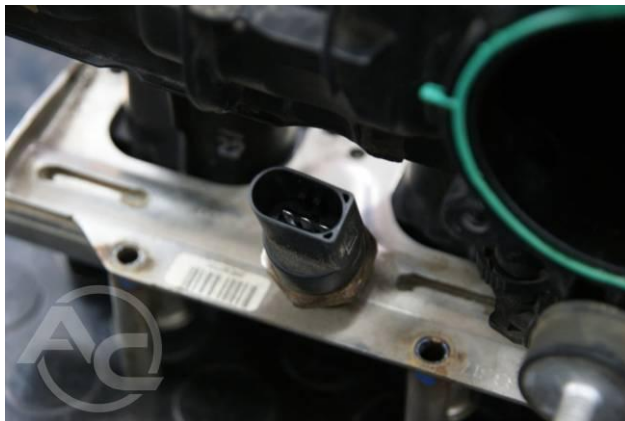
Рис. 1.3.36 Датчик давления топливной планки
