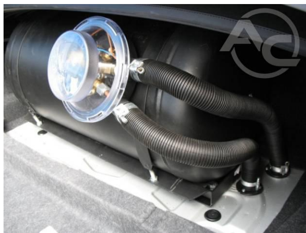
Рис. 1.3.15 Общий вид газонепроницаемых шлангов
